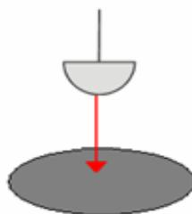
On détermine la masse, en gramme, nécessaire pour percer la gaine.
